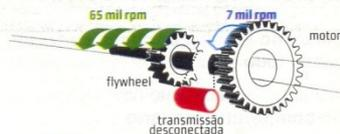
**2 FRENAGEM** Ao entrar numa curva, o piloto freia. Com isso, o carro desacelera e o motor perde rotações. Mas a *flywheel* se desconecta do resto do motor, e por isso continua girando a toda velocidade. Ela conserva energia.
