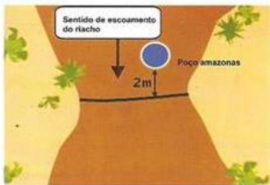
Figura 1. Local de instalação do poço Amazonas.
