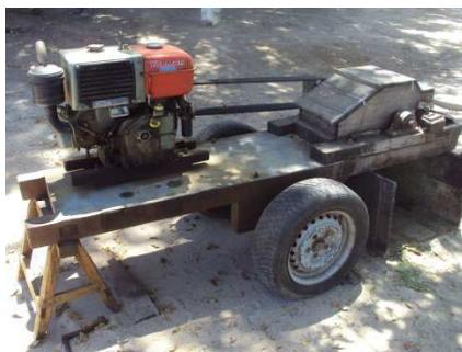
**Figura 1.** Máquina “Paraibana” utilizada no processo de desfibramento das folhas de sisal.
