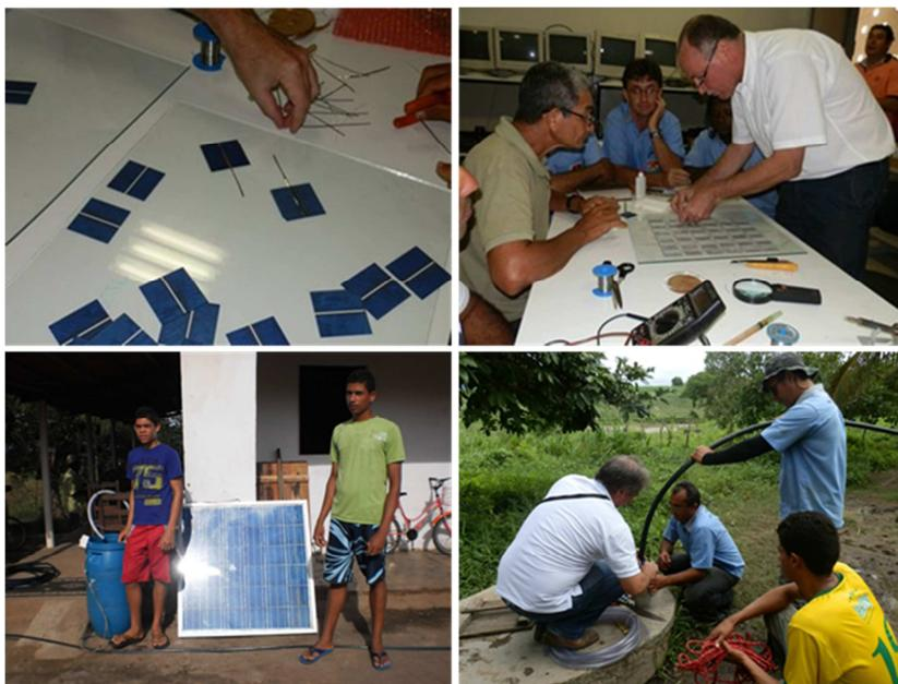
Figuras 9 a 12. Construção e implantação de painel solar - UDPAF do PA Penha I – Alagoa Grande.
